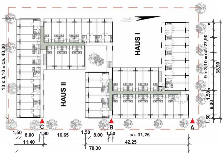
(Bild 2) Grundriss des 1. OG: Hier steht alles miteinander in Verbindung über Flure, Laubengänge und die kleinen Brücken im Treppenhausturm. Die drei Eingänge im EG sind mit roten Pfeilen markiert.
